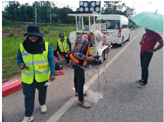
รูปที่ 3.5 การวัดอุณหภูมิชั้นทางแอสฟัลต์คอนกรีตและการเจาะสำรวจชั้นทางเบื้องต้น
