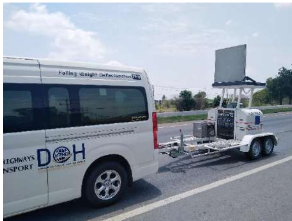
รูปที่ 3.1 เครื่องมือ Falling Weight Deflectometer (FWD)
