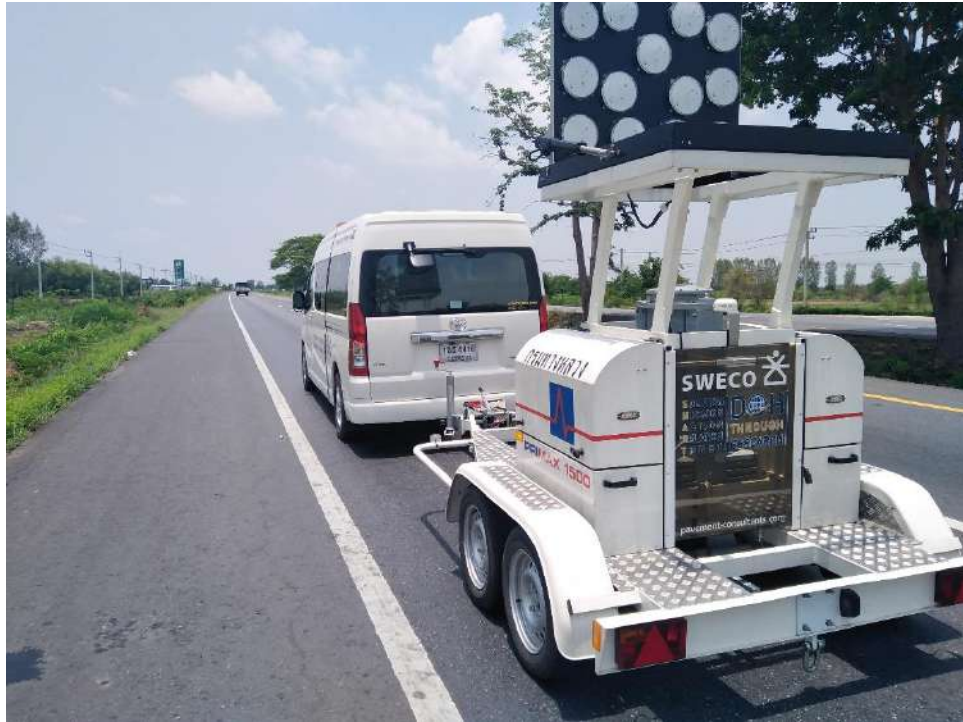
รูปที่ 3.4 การทดสอบค่าการแอ่นตัวด้วยเครื่องมือ FWD
